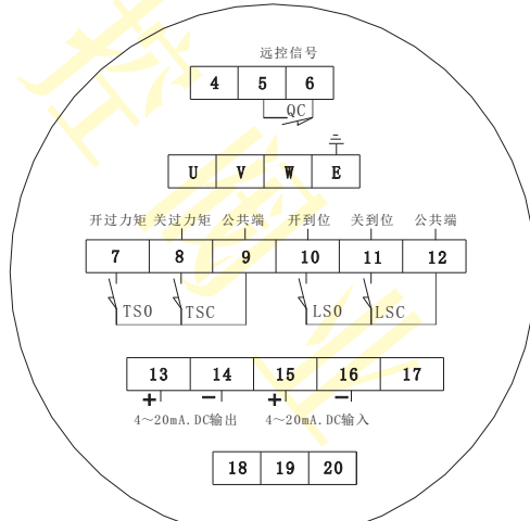
图7 防爆调节型接线图
